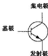
在基极施加微小的电压就可以控制非常大的电压从集电极到发射极。如果在基极没有施加电压，那么晶体管将不起作用。
