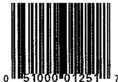
我们要试着将条形码形象地看成是细条和黑条、窄间隙和宽间隙的排列，事实上，这就是观察条形码的一种方式。在 UPC 中，黑色条纹有四种不同的宽度，宽条纹的宽度分别是最细条纹宽度的两倍、三倍或四倍。同样，宽间隔的宽度分别是最窄间隔宽度的两倍、三倍或四倍。
