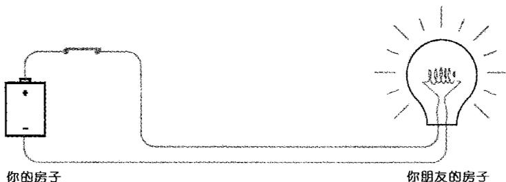
现在，你可以用莫尔斯码来发信息了。既然你已经成功地安装了这个“手电筒”，你就可以照样再安装另一套这样的“远距离”设备，好让你的朋友也能够给你发信息。
